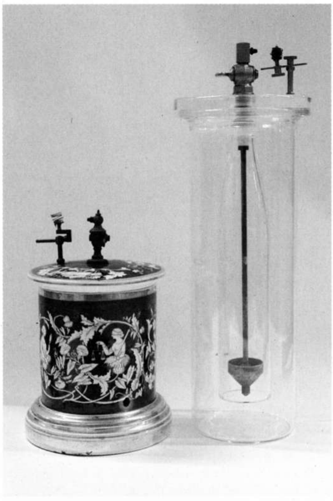
Abbildung 1: Döbereiner-Feuerzeug im Original und als Nachbau aus Glas.
