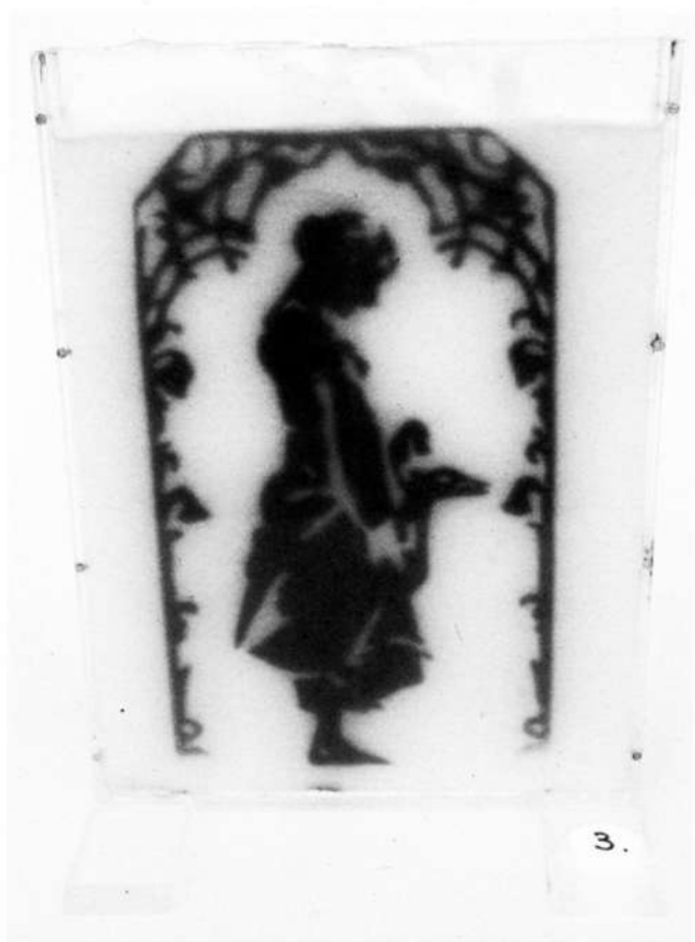
Abbildung 2: Durch eine Photoreaktion färben sich die belichteten Stellen des Gels blau.
