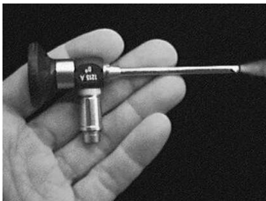
Abbildung 3: Medizinisches Endoskop mit Glasfasern [1].
