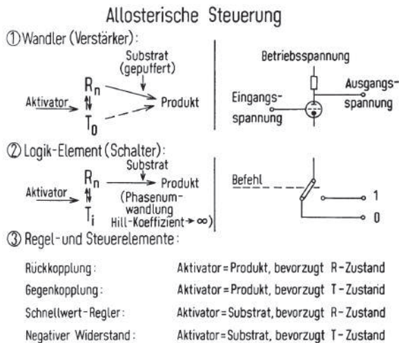
Abbildung 22: Vergleich eines allosterischen Enzyms (nach Abb. 21) mit einem elektronischen Schaltelement. Der Aktivator hat die Rolle eines Steuergitters. Der Umsatz des Substrats in ein Reaktionsprodukt entspricht dem zu steuernden Strom. T und R bezeichnen die verschiedenen Konformationen des Enzyms (T z. B. Quadrate; R Kreise in Abb. 21). Die enzymatische Aktivität ist auf die R-Form beschränkt, d. h. in der T-Form findet kein Umsatz statt (vgl. auch Lit. [66]).
