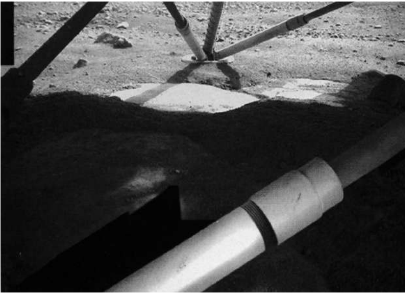
Abbildung 6: Mit dem Greifarm grub die Phoenix -Sonde am Fuß ihres Landegestells einen hellen, glatten Block aus, den die Wissenschaftler für Eis halten (Bildnachweis: M. Di Lorenzo, K. Kremer, NASA/JPL/UA/MPS/Spaceflight).
