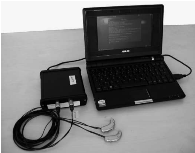
Abbildung 8: Digitales, binaurales Master-Hörgerät, das im BMBF-geförderten Kompetenzzentrum HörTech für die Entwicklung verschiedener digitaler Hörgerät-Algorithmen genutzt wurde. Im EU-Projekt Hearcom dient es jetzt 29 Partnern als gemeinsame Hard- und Software-Plattform zum Vergleich unterschiedlicher Algorithmen (Bildnachweis: http://www.hearcom.eu ).
